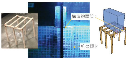
3班の模型基礎(唯一の杭基礎でのチャレンジ)
