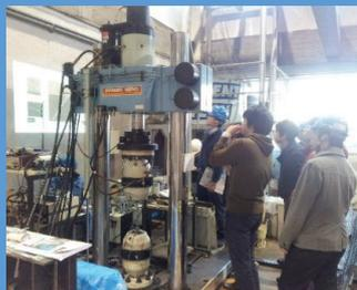
座屈は圧縮部材で見られる重要な現象である。複数の細長い鋼材を座屈させることで、座屈荷重を理論解と比較する。
