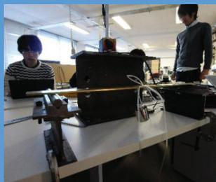
単純ばりを曲げ载荷し、材料定数の同定と構造力学の諸原理・定理の確認を行う。振動実験では片持ちばりの振動数等を調べる。
